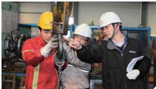
检查起重机车吊钩安全
